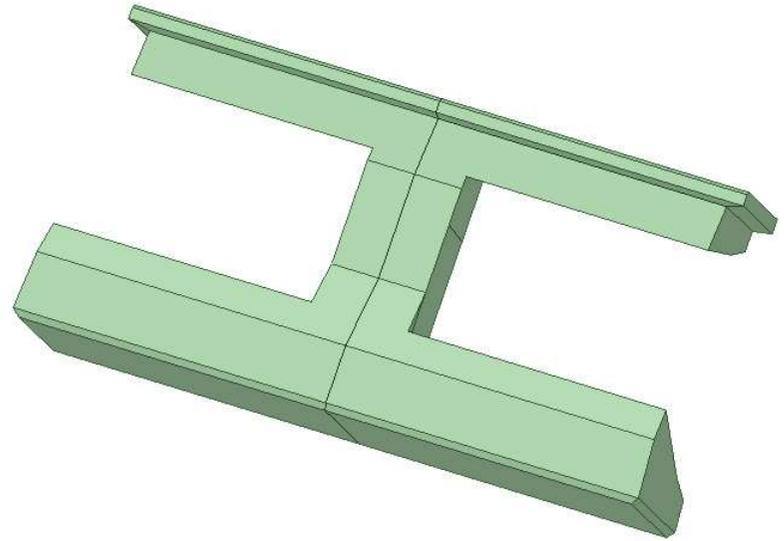
県型ブロック基礎 幅550mm 長さ1.0m 高さ250mm
