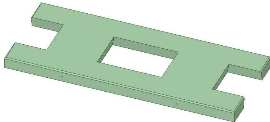
県型ブロック基礎 基礎板 幅800mm 長さ2.0m 厚さ100mm 吊り下げ用インサート4か所
