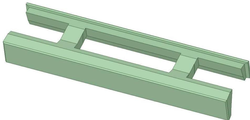
県型ブロック基礎 幅550mm 長さ2.0m 高さ250mm
